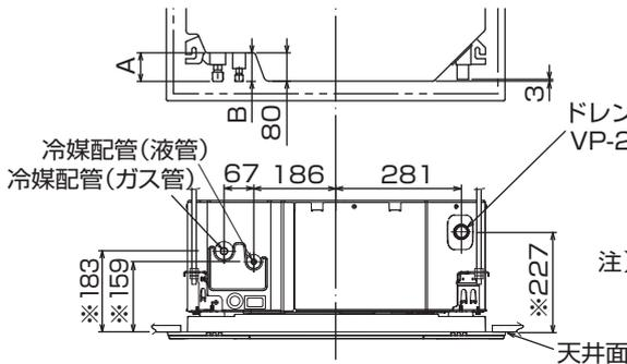
ドレン配管 (ソケットもしくは付属のフレキホースを接続 VP-25接続 (塩ビ系接着剤にて接着))
