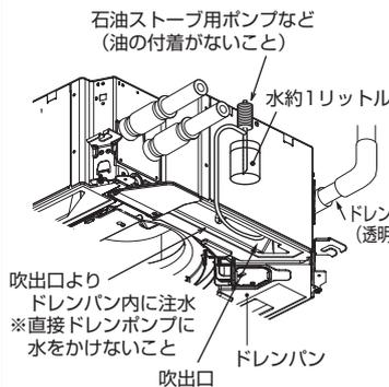
注1) 左記水量を注水しても排水確認ができない場合は、水平に据え付けられていない可能性があります。水準器などを使用して本体が水平に設置されているか確認してください。また、必要以上の水を注水するとドレンポンプが水没し、故障の原因になります。
