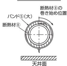
※断熱材⑧の巻き始めが据付状態で上側になるように貼付けする。
