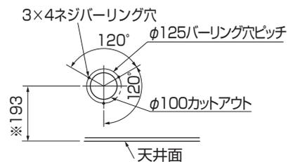
注) 図中の※印部の寸法は、別売外気取入用ケースメントを取り付けた場合135mm加算します。
