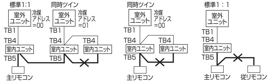
■リモコン線の総延長は500mです。ただし、リモコンを2台接続(例2)、(例3)でご使用の場合は200m以下にしてください。
