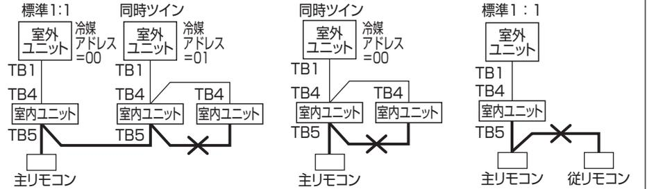
■リモコン線の総延長は500mです。ただし、リモコンを2台接続(例2)、(例3)でご使用の場合は200m以下にしてください。
