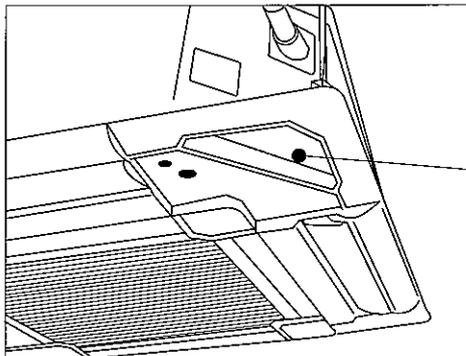
カンタンコーナポケットよりスパナ等の一般工具にて、ユニット本体のナットを微調整する。
