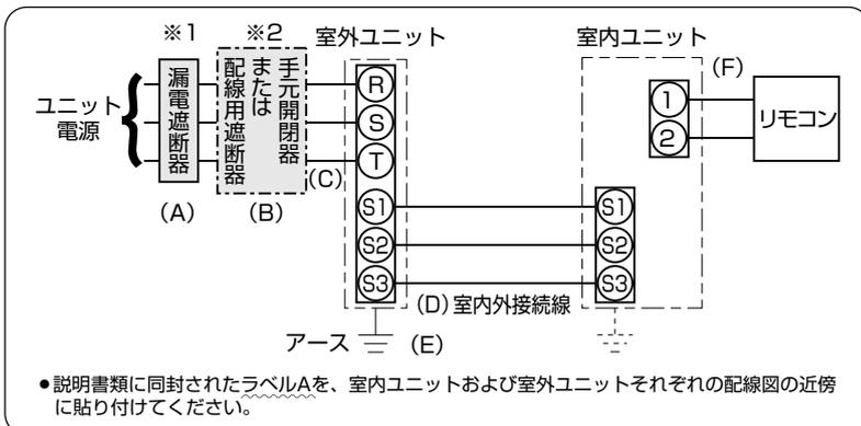
※1 電源には必ず漏電遮断器を取付けてください。漏電遮断器は、インバーター回路用遮断器(三菱電機製NV-Cシリーズまたは、その同等品)を選定してください。
