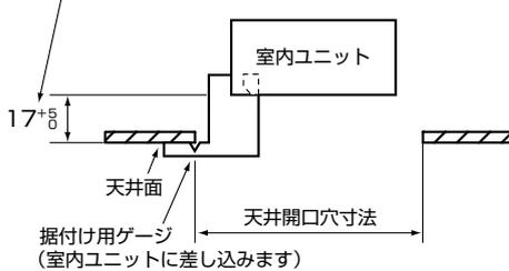
※化粧パネルを取付け後、室内ユニットの吊り高さの微調整ができます。
