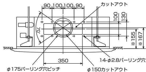
注) 図中の※印部の寸法は、別売多機能ケースメントを取付けた場合、※印寸法に135mm加算します。
