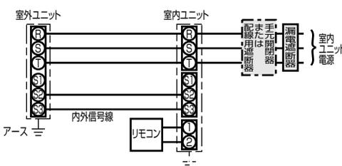
**室内ユニットの電源をS1およびS2に接続**
