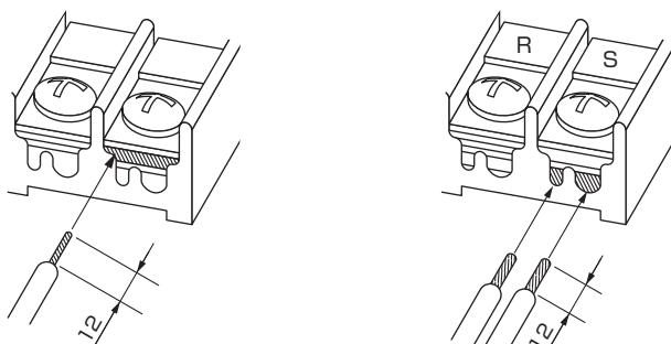
室内外伝送線またはリモコン線などの細いケーブルは、必ず図示位置に接続してください。
