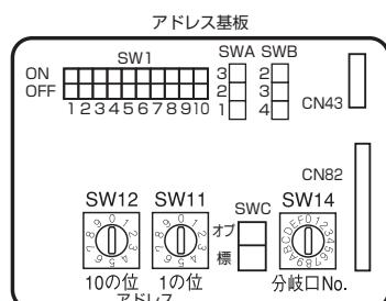
アドレス設定はアドレス基板上のロータリスイッチにて設定します。
