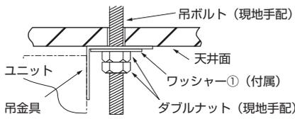
※吊金具下の締付けナットを締め上げて天井がもち上がる場合は、右図の固定とってください。
