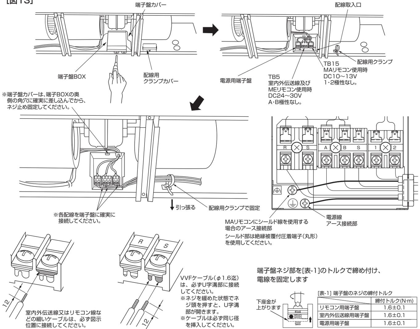
[表-1] 端子盤のネジの締付トルク
