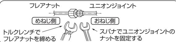
5. 冷媒配管接続部のガス漏れ確認する。
