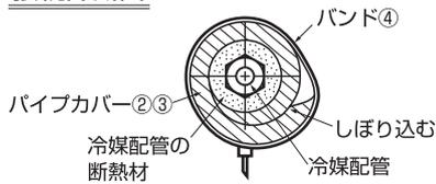
後配管の際、後配管穴カバーは斜線部を切り離し、必ず元の位置へ取付けて下さい。(埃の進入により、熱交換器が目詰まりするおそれがあります)
