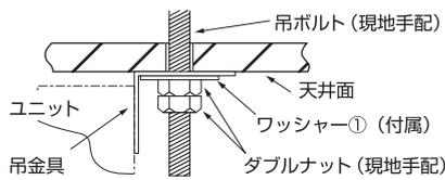
※吊金具下の締付けナットを締め上げて天井がもち上がる場合は、右図の固定とさせていただきます。
