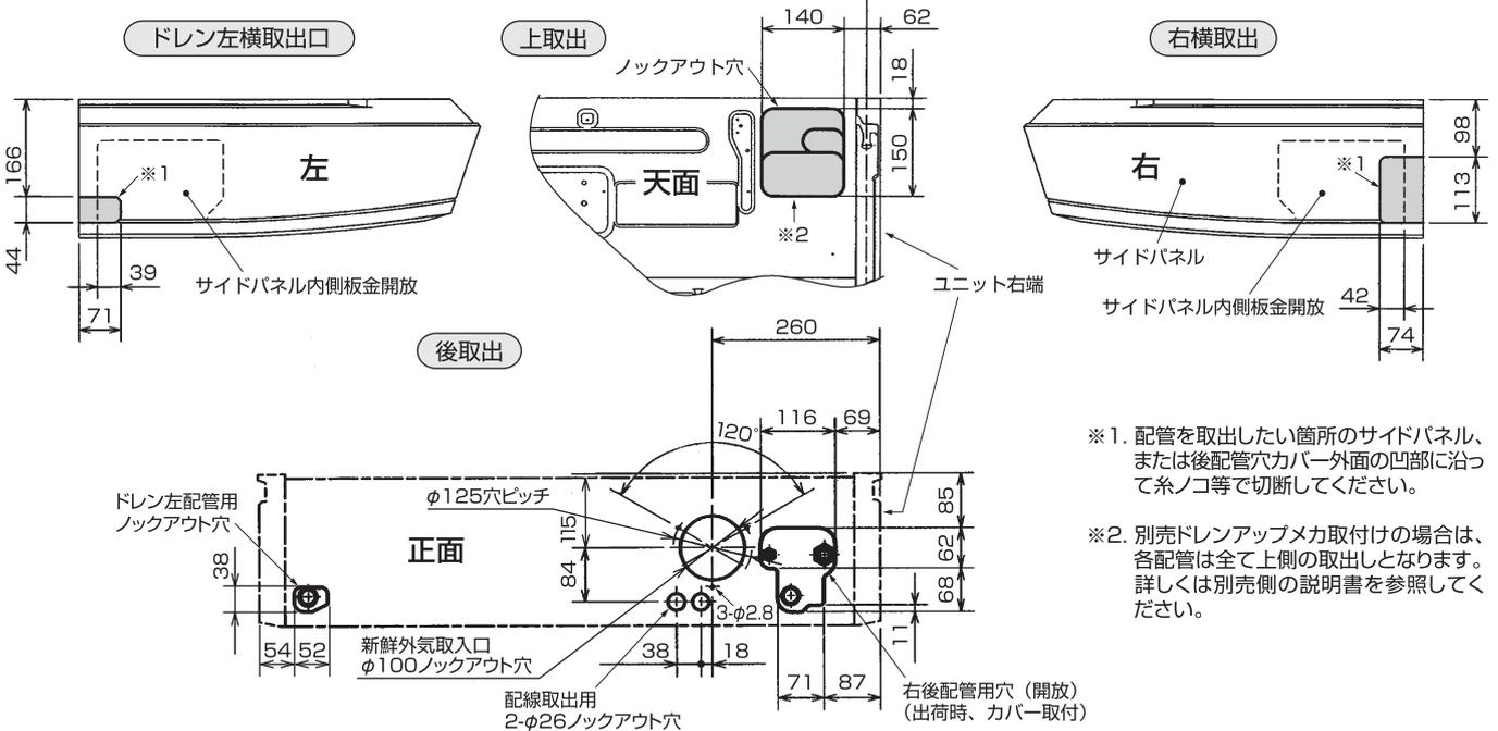
後配管の際、後配管穴カバーは斜線部を切り離し、必ず元の位置へ取付けて下さい。
