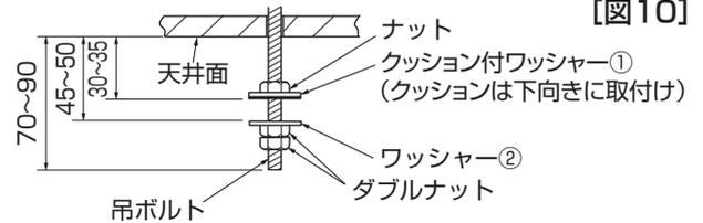
【防振ゴムを使用する場合】 防振ゴムを使用する際は、強度低下の原因になる可能性がありますので、下記のような施工を推奨します。
