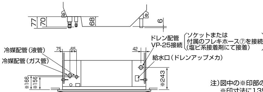
注) 図中の※印部の寸法は、別売多機能ケースメントを取付けた場合、※印寸法に135mm加算します。
