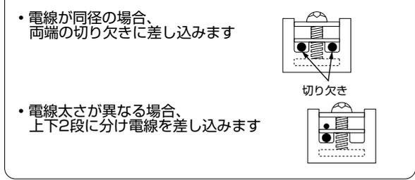
1-③ 端子台ネジ部を1.6±0.1N・mのトルクで締め付け、電線を固定します
