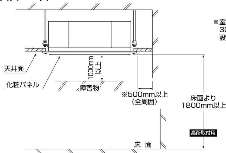
※室内ユニット間の距離は、3000mm以上離して設置してください。
