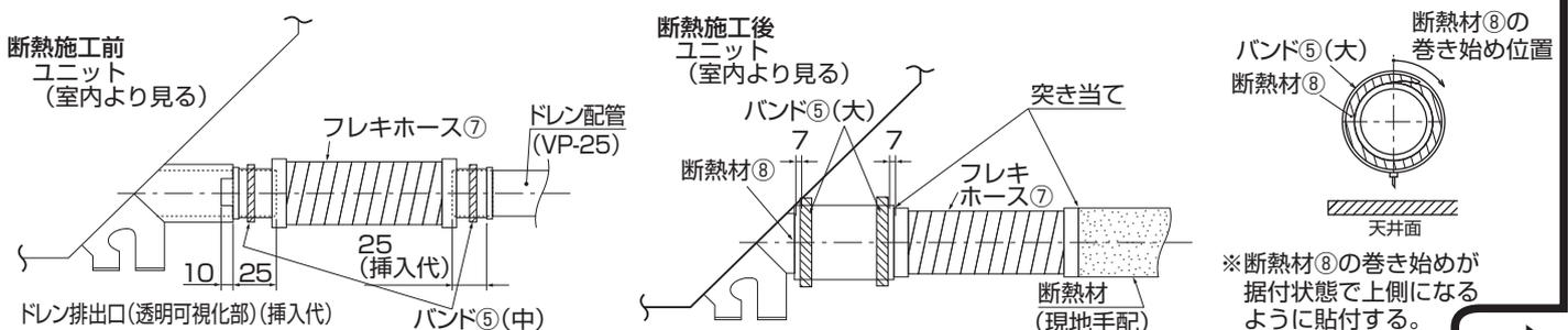
※断熱材⑧の巻き始めが据付状態で上側になるように貼付する。
