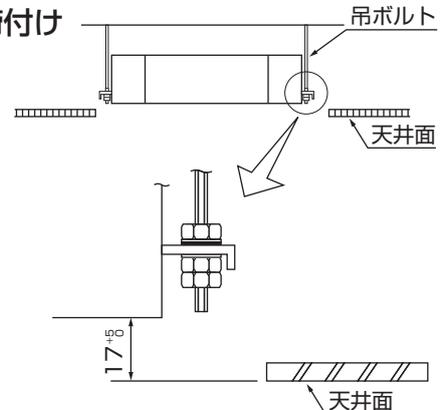
※化粧パネルを取付け後、室内ユニットの吊り高さの微調整ができます。
