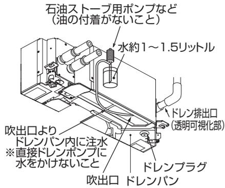
注1) 左記水量を注水しても排水確認ができない場合は、水平に据付けられていない可能性があります。水準器などを使用して本体が水平に設置されているか確認してください。また、必要以上の水を注水するとドレンポンプが水没し、故障の原因になります。
