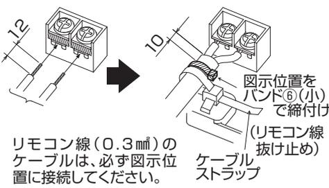
1. 内外接続線にVVF平形ケーブルを使用する場合は以下の作業手順に従い配線を行ってください。
