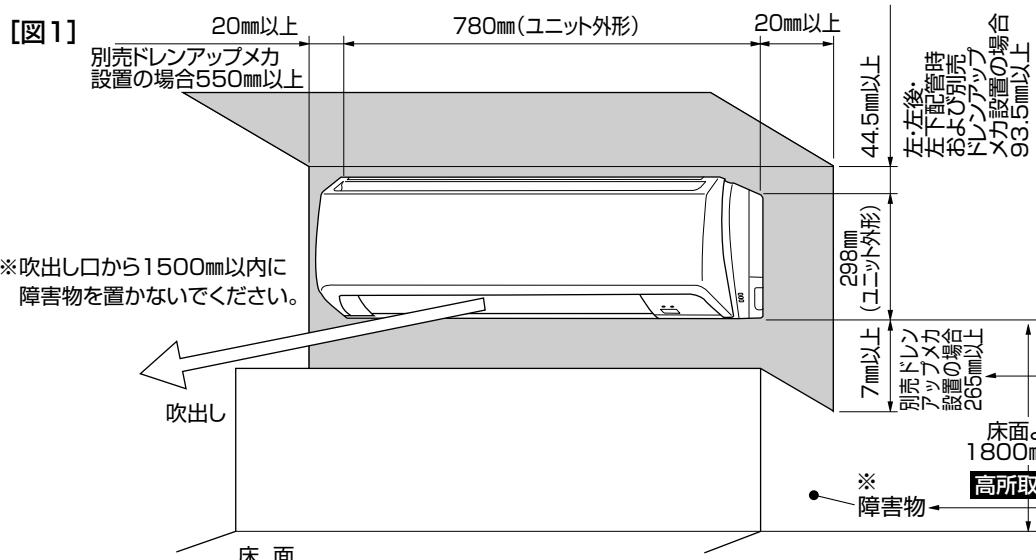
カーテンレールなどの壁からの突出寸法が60mmを超える場合には、吹出し気流がショートサイクルを起こす場合がありますので、さらに十分な距離をとってください。
