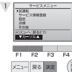
2 試運転メニューが表示されますので、「試運転操作」を選択し **決定** ボタンを押します。
