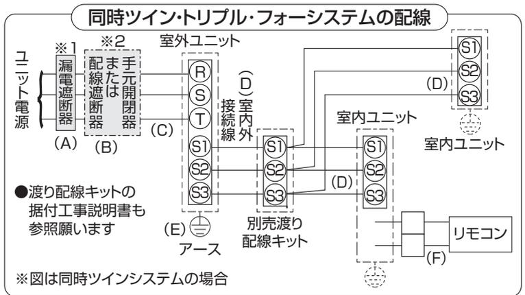
※1 電源には必ず漏電遮断器を取付けてください。漏電遮断器は、インバーター回路用遮断器(三菱電機製NV-Cシリーズまたは、その同等品)を選定してください。
