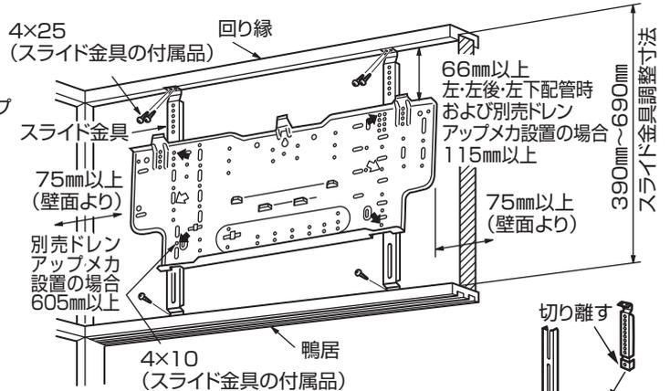
据付板①をスライド金具上側と下側が重ならない部分で固定する場合は、右図のようにスライド金具の下部を切り離して、固定してください。
