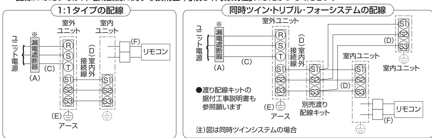
※電源には必ず漏電遮断器を取付けてください。漏電遮断器は、地絡・過負荷・短絡保護兼用のインバーター回路用遮断器(三菱電機製NV-Cシリーズ又は、その同等品)を選定してください。
