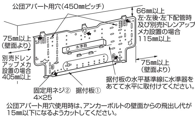
据付け板①の微振動を防ぐため、➡位置の穴は必ず固定してください。
