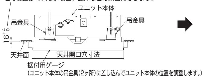
\*1 化粧パネルを取り付け後、ユニットの高さの微調整ができます。
