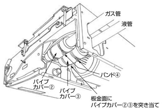
後配管の際、後配管穴カバーは斜線部を切り離し、必ず元の位置へ取付けて下さい。(ほごりの進入により、熱交換器が目詰まりするおそれがあります。)
