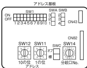
アドレス設定は電気品カバーをはずし、アドレス基板上のロータリースイッチにて設定します。
