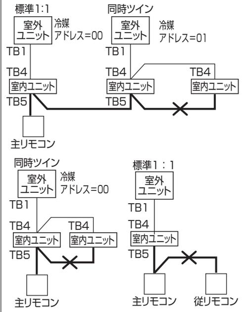
■リモコンコードの総延長は500mです。ただし、リモコンを2台接続(例2)、(例3)でご使用の場合は200m以下にしてください。
