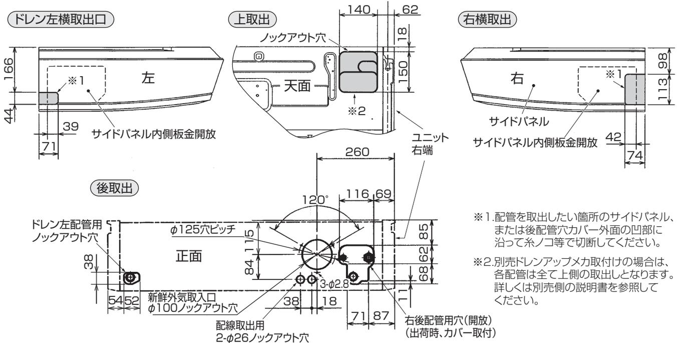
後配管の際、後配管穴カバーは斜線部を切り離し、必ず元の位置へ取付けてください。
