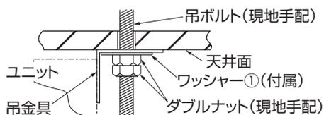
※吊金具下の締付けナットを締め上げて天井がもち上がる場合は、右図の固定としてください。
