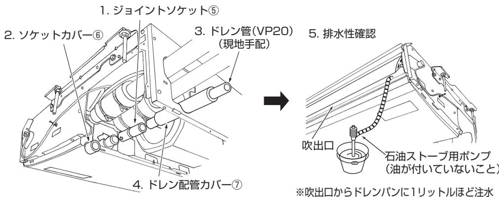
後配管の際、後配管穴カバーは斜線部を切り離し、必ず元の位置へ取付けてください。(埃の進入により、熱交換器が目詰まりするおそれがあります)
