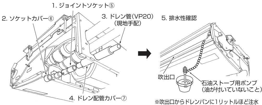
後配管の際、後配管穴カバーは斜線部を切り離し、必ず元の位置へ取付けてください。
