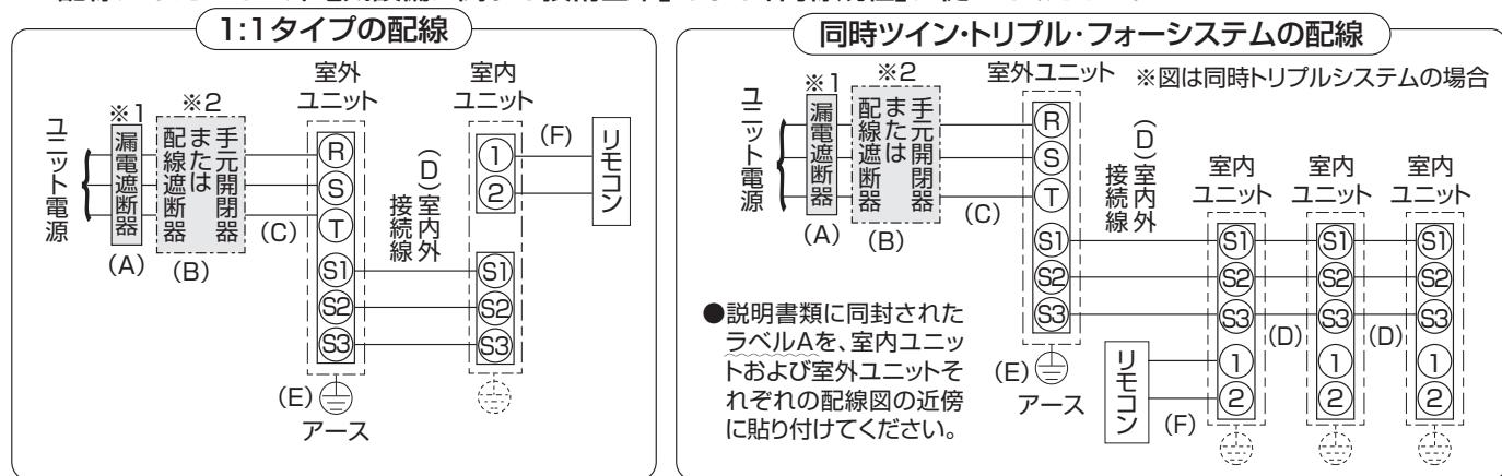
※1 電源には必ず漏電遮断器を取付けてください。漏電遮断器は、インバーター回路用遮断器(三菱電機製NV-Cシリーズまたは、その同等品)を選定してください。
