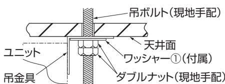
※吊金具下の締付けナットを締め上げて天井がもち上がる場合は、右図の固定としてください。
