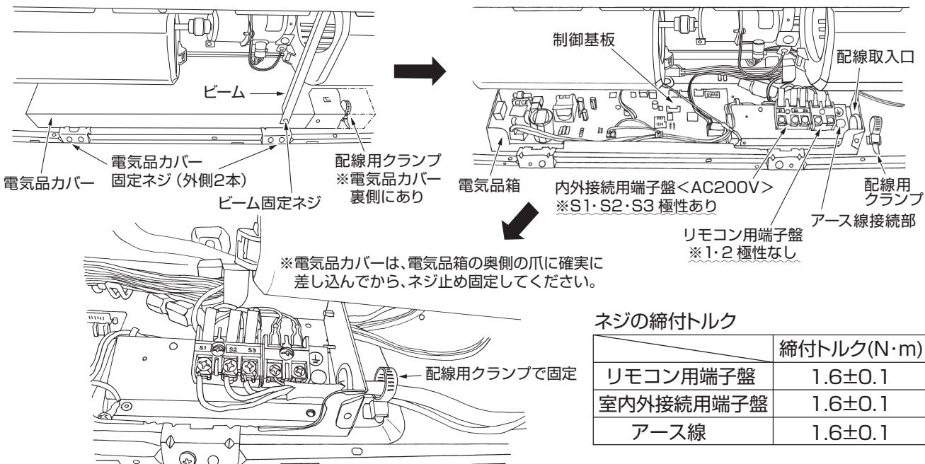
1. 内外接続線にVVVF平形ケーブルを使用する場合は以下の作業手順に従い配線を行ってください。
