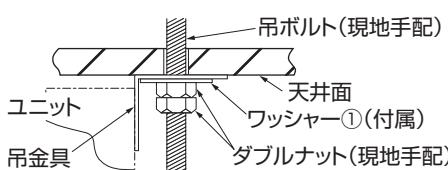
※吊金具下の締付けナットを締め上げて天井がもち上がる場合は、右図の固定としてください。
