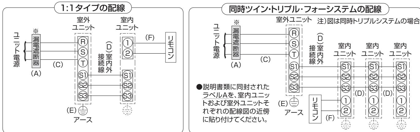
※ 電源には必ず漏電遮断器を取付けてください。漏電遮断器は、地絡・過負荷・短絡保護兼用のインバーター回路用遮断器（三菱電機製NV-Cシリーズまたは、その同等品）を選定してください
