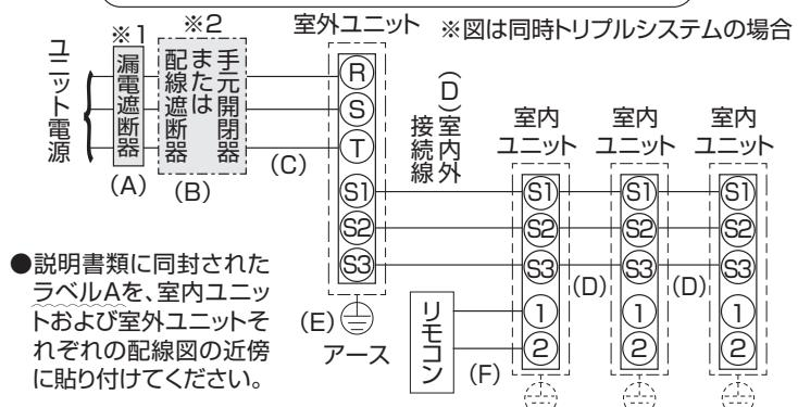
※1 電源には必ず漏電遮断器を取付けてください。漏電遮断器は、インバーター回路用遮断器(三菱電機製NV-Cシリーズまたは、その同等品)を選定してください。
