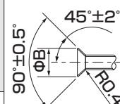
※従来のツールを使って冷媒R32用またはR410A用のフレア加工をする場合は、上表を参考に加工してください。
