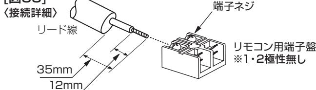
[図34] アース線は、図の方向で接続してください。
