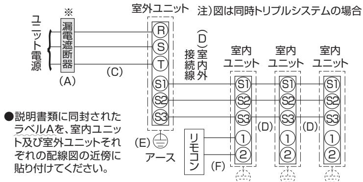
※ 電源には必ず漏電遮断器を取り付けてください。漏電遮断器は、地絡・過負荷・短絡保護兼用のインバーター回路用遮断器（三菱電機製NV-Cシリーズ又は、その同等品）を選定してください。
