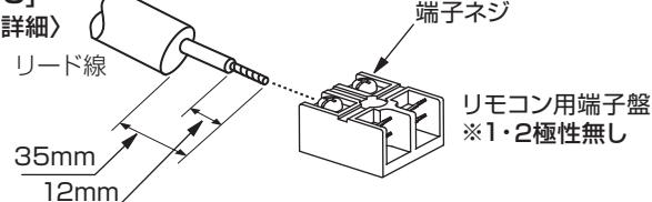
[図34] アース線は、図の方向で接続してください。
