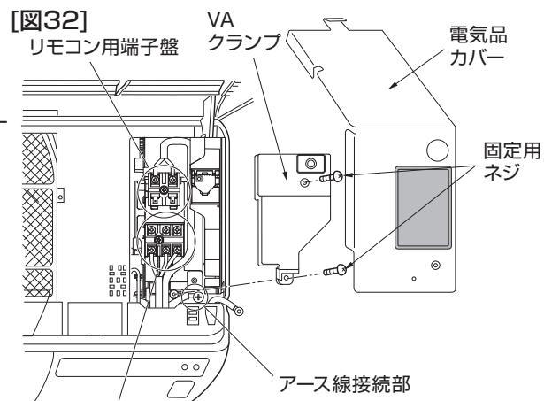
室内外接続用端子盤(AC200V)※S1・S2・S3極性有り
