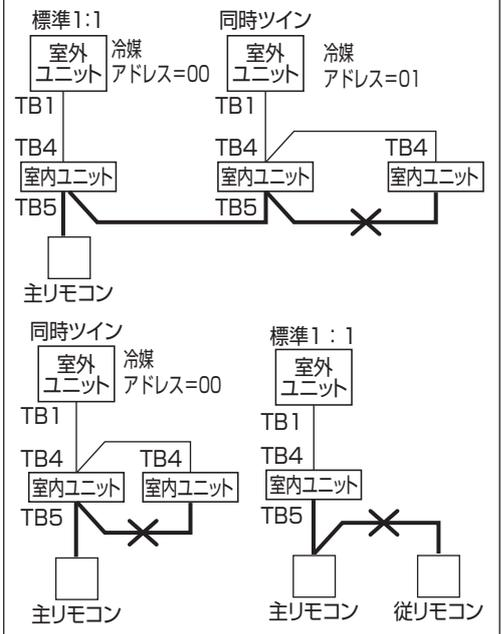
■リモコン線の総延長は500mです。ただし、リモコンを2台接続(例2)、(例3)でご使用の場合は200m以下にしてください。
