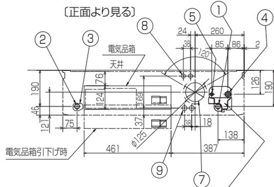
後配管の際、後配管穴が<sup>レ</sup>は斜線部を切り離し必ず元の位置へ取付けて下さい。(埃の進入により、熱交換器が目詰まりするおそれがあります)
