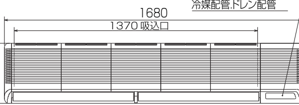
左配管用 ノックアウト穴 冷媒配管・ドレン配管
