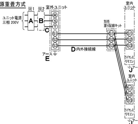
※制御線・電源線分離方式(室外ユニットより室内ユニットに電源を供給する方式)、制御線単独方式(内外別受電方式)は、できません。
