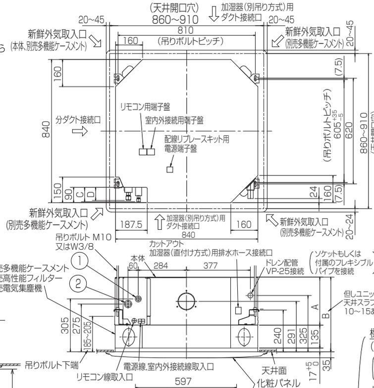
加湿器(別吊り方式)用ダクト接続口詳細図(両側面)
