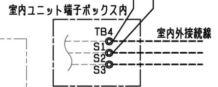
注. --- (太破線) : 現地配線 / - - - (細破線) : 室内ユニット配線
