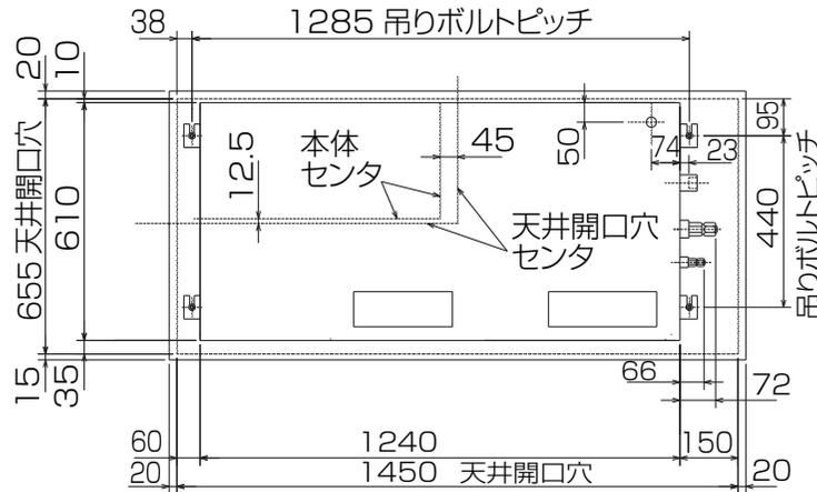
新鮮外気取入口 (ノックアウト) 左側面図
