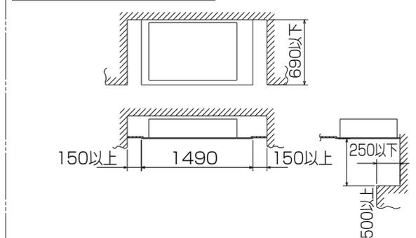
配管,配線,メンテナンスは下面及び右側面となっておりますので,上記スペースを確保してください。なお,吊込時の作業性と安全性を考慮して,できるだけ多くのスペースを確保してください。
