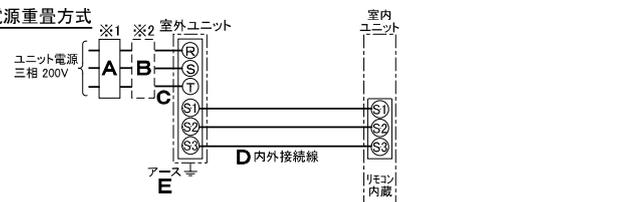
※室内外の渡り配線の総延長が80m以上となる場合は、電源重畳方式での配線はできません。必ず(2)内外別受電方式あるいは(3)室外ユニットより室内ユニットに電源を供給する方式にしてください。
