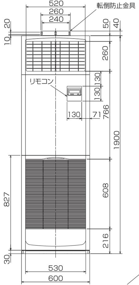
冷媒、ドレン配管用ロックアウト穴 90×60長穴(左側面にも同等穴有り)
