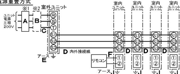
※室内外の渡り配線の総延長が80m以上となる場合は、電源重畳方式での配線はできません。必ず(2)内外別受電方式あるいは(3)室外ユニットより室内ユニットに電源を供給する方式にしてください。
