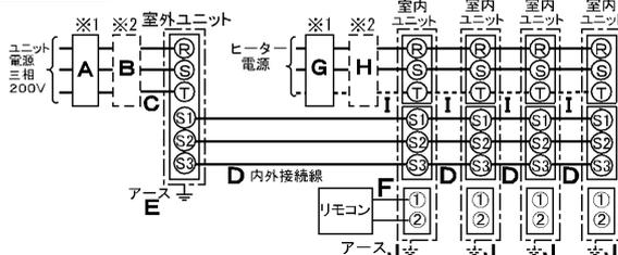
※室内外の渡り配線の総延長が80m以上となる場合は、電源重畳方式での配線はできません。必ず(2)内外別受電方式にしてください。
