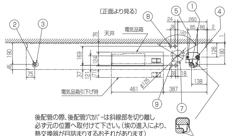
後配管の際、後配管穴カバーは斜線部を切り離し必ず元の位置へ取付けて下さい。(埃の進入により熱交換器が目詰まりするおそれがあります)
