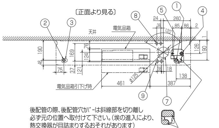
後配管の際、後配管穴が<sup>φ</sup>-は斜線部を切り離し必ず元の位置へ取付けて下さい。(埃の進入により、熱交換器が目詰まりするおそれがあります)
