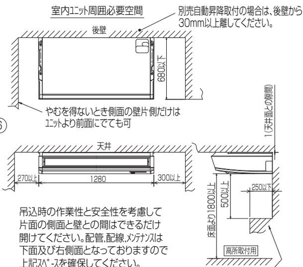
吊込時の作業性と安全性を考慮して片面の側面と壁との間はできるだけ開けてください。配管、配線、メチナスは下面及び右側面となっておりますので上記<sup>φ</sup>-sを確保してください。
