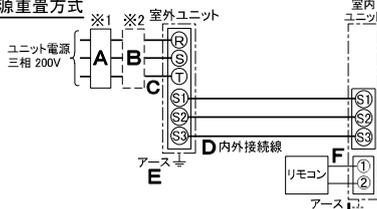
※室内外の渡り配線の総延長が80m以上となる場合は、電源重畳方式での配線はできません。必ず(2)内外別受電方式あるいは(3)室外ユニットより室内ユニットに電源を供給する方式にしてください。
