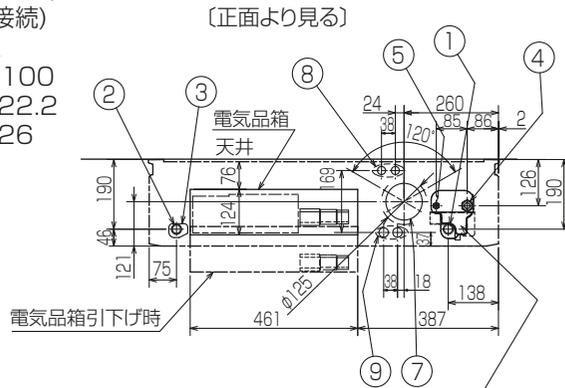
後配管の際、後配管穴が\*は斜線部を切り離し必ず元の位置へ取付けて下さい。(埃の進入により、熱交換器が目詰まりするおそれがあります)
