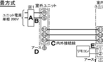
\*室内外の渡り配線の総延長が80m以上となる場合は、電源重畳方式での配線はできません。必ず(2)内外別受電方式あるいは(3)室外ユニットより室内ユニットに電源を供給する方式にしてください。
