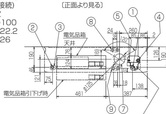
後配管の際、後配管穴が<sup>\*</sup>は斜線部を切り離し必ず元の位置へ取付けて下さい。(埃の進入により、熱交換器が目詰まりするおそれがあります)
