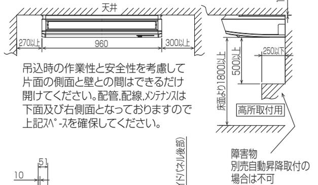
吊込時の作業性と安全性を考慮して片面の側面と壁との間はできるだけ開けてください。配管、配線、メンテナンスは下面及び右側面となっておりますので上記スペースを確保してください。
