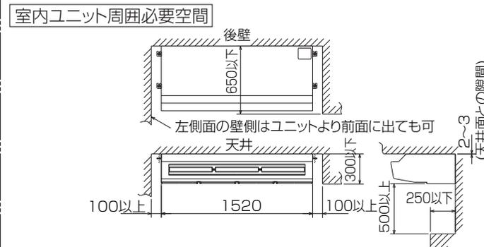
吊込時の作業性と安全性を考慮して片方の側面と壁との間はできるだけ開けてください。配管、配線、メンテナンスは下面及び右側面となっておりますので上記スペースを確保してください。
