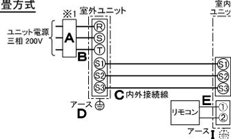
※室内の渡り配線の総延長が90m以上となる場合は、電源重畳方式での配線はできません。必ず(2)内外別受電方式あるいは(3)室外ユニットより室内ユニットに電源を供給する方式にしてください。
