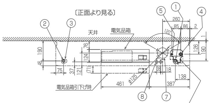
後配管の際、後配管穴が<sup>°</sup>-は斜線部を切り離し必ず元の位置へ取付けて下さい。(埃の進入により、熱交換器が目詰まりするおそれがあります)
