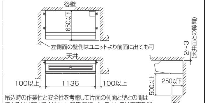
吊込時の作業性と安全性を考慮して片面の側面と壁との間はできるだけ開けてください。配管、配線、メンテナンスは下面及び右側面となっておりますので上記スペースを確保してください。
