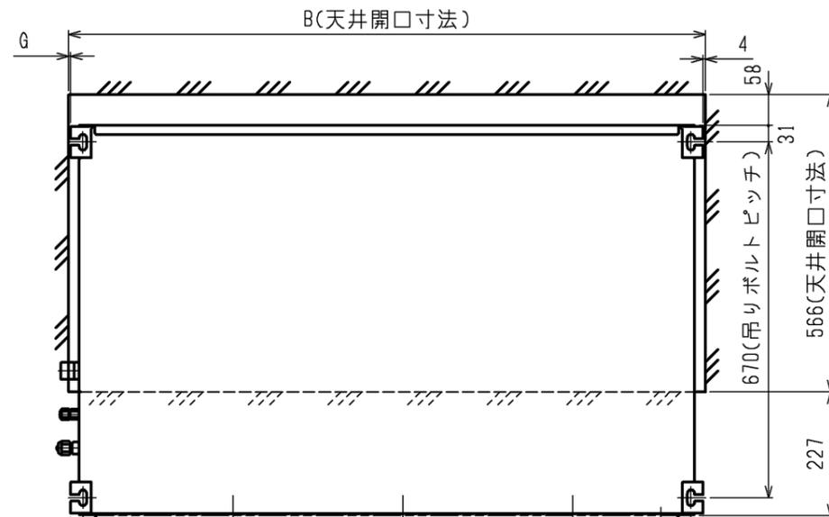
1. オプションの高性能フィルタ組込時は本体高さが32mmアップします。
