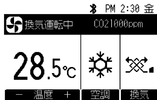
メイン画面(空調換気)
