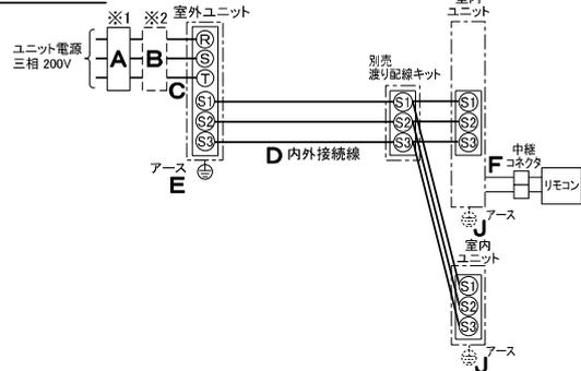
※ 制御線・電源線分離方式(室外ユニットより室内ユニットに電源を供給する方式)、制御線単独方式(内外別受電方式)は、できません。
