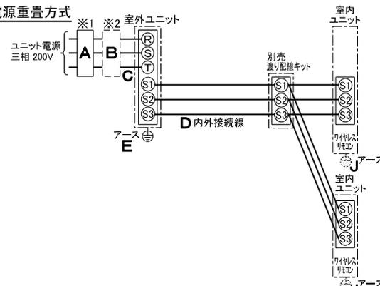
※ 制御線・電源線分離方式(室外ユニットより室内ユニットに電源を供給する方式)、制御線単独方式(内外別受電方式)は、できません。
