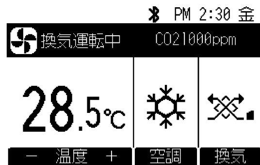
メイン画面(空調換気)
