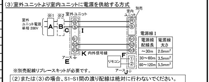
※1. 電源には必ず漏電遮断器を取付けてください。漏電遮断器は、インバーター回路用遮断器(三菱電機製NV-Cシリーズまたは、その同等品)を選択してください。
