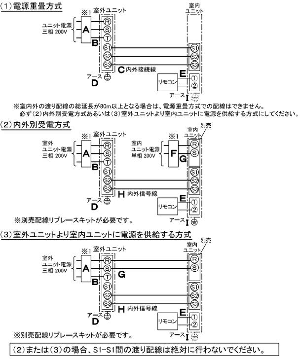
※1. 電源には必ず漏電遮断器を取付けてください。
